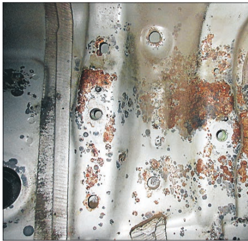
Undervogn blæst med tøris, og nu kan det ses, hvor meget rust der er inde bagved.
