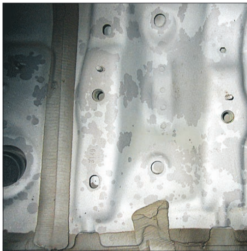
Efter anden blæsning til renhedsgrad SA 2,5
